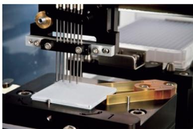
SmartChip MultiSample NanoDispenserは、8チャンネルのノズルによって、アッセイプレートとサンプルプレートからSmartChipに反応液を分注します。14通りの分注パターンがインストールされています。
