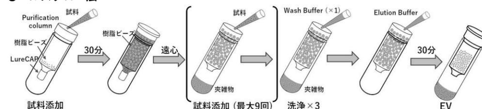
パルスフロー法は試料中の EV が低濃度かつ試料量が多い場合に適応できる精製方法です。最大 4.6mL までの試料から EV の精製が可能です。
