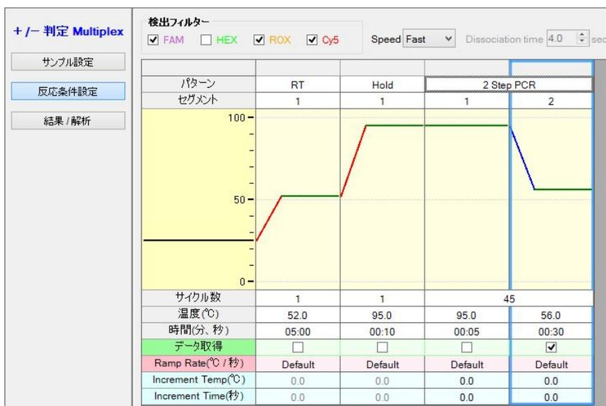
Thermal Cycler Dice Real Time PCR System III の設定例
