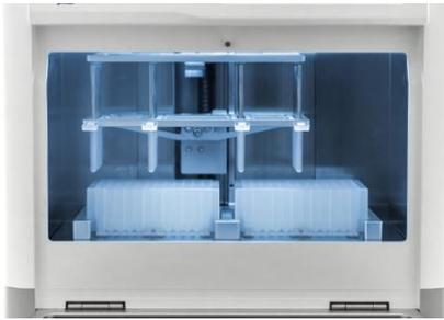
本体内蔵のUVランプで細菌、ウイルスおよび浮遊ゲノムDNA汚染物質などを効果的に除去します。また、浄化フィルターシステムによりクロスコンタミネーションを低減します。
