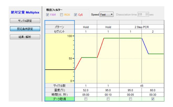
※上図は、Thermal Cycler Dice Real Time PCR System III の設定例です。
